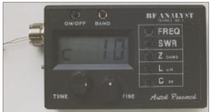
Bild 5: Das RF-1 von Autek/stabo bei der Messung einer Kapazität von 10 pF Fotos: DL7UMO
