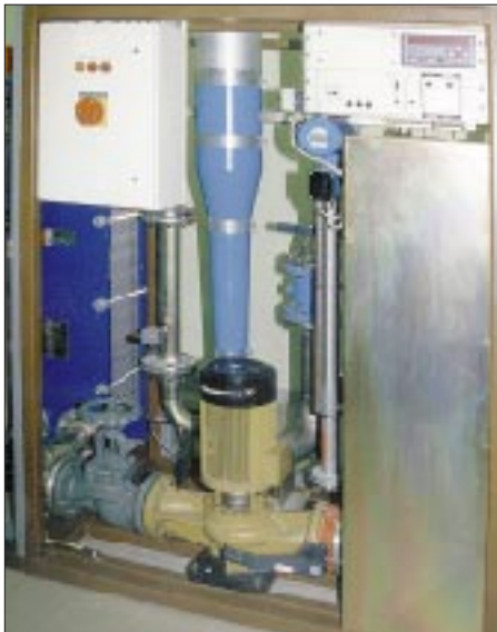
Die Kunstantenne erinnert an eine Pumpstation. Der eigentliche Abschlußwiderstand ist der sich rechts befindende Metallzylinder, links daneben das 50- \Omega -Koaxial„kabel“.
