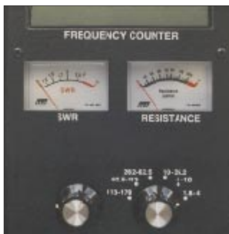
Bild 4: MFJ-259-Teilansicht mit Frequenzeinstellung, Bereichsschalter, Anzeigeelementen und Display
